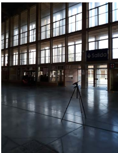
Ilustración 3. Desarrollo de mediciones de tiempo de reverberación.
