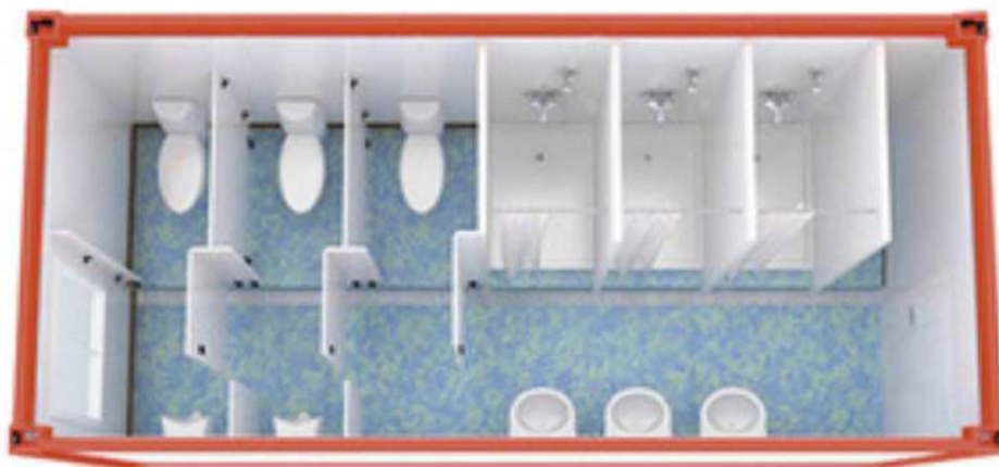
Figura: Ejemplo de bloque higiénico resuelto mediante contenedor marítimo
