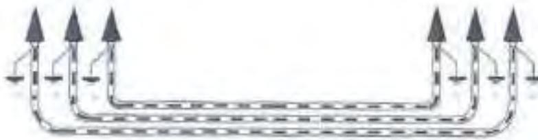
Ilustración 8. Puesta a tierra cubiertas metálicas
