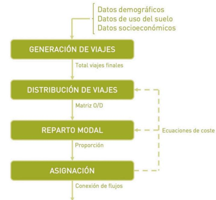
Gráfico 3. Esquema del método de los cuatro pasos.
