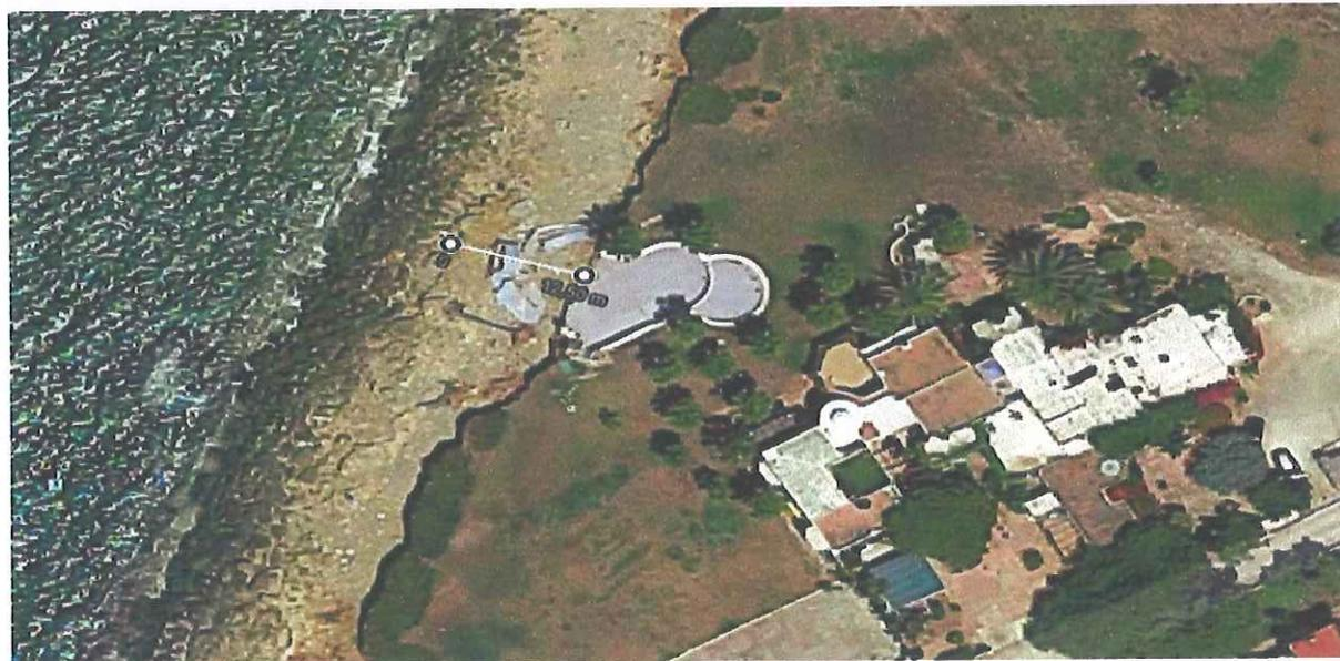
Fig. 2 y 3. Entre La Punta de Montijo y Chipiona se está produciendo una erosión extraordinaria. En solo unas semanas los temporales de 2018 provocaron un retroceso de la costa de más de 10 m como puede apreciarse en esta pareja de fotografías de *Google Maps* tomadas antes y después de dichos temporales. La subida del nivel del mar y la mayor intensidad de los temporales provocadas por el Cambio Climático acelerarán aún más estos procesos en las próximas décadas.
