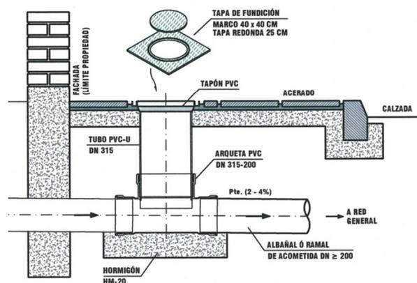
El tubo vertical hasta el nivel del acerado será de PVC-U de pared compacta DN 315 mm con tapón de PVC incorporado para evitar la salida de gases y olores. Y en la parte superior se rematará, a nivel de acerado, con un registro de fundición dúctil, de marco cuadrado de 40 x 40 cm y tapa redonda con sello anti-olores de 25 cm de diámetro.
