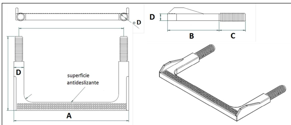
El pate tendrá el diseño adecuado para que el travesaño de apoyo tenga topes laterales que impidan el deslizamiento lateral del pie.
