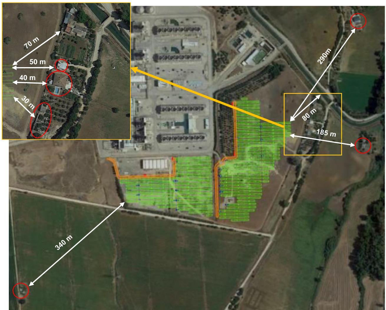
Dentro de la misma parcela de IBERDROLA se localizan, además de la propia CCC Arcos, diversas infraestructuras asociadas al funcionamiento de la misma, como la subestación y líneas eléctricas, la planta de tratamiento de aguas o una estación meteorológica. Estas infraestructuras y su ubicación y distancia respecto a la PFV se representan en la Figura 2.5.
