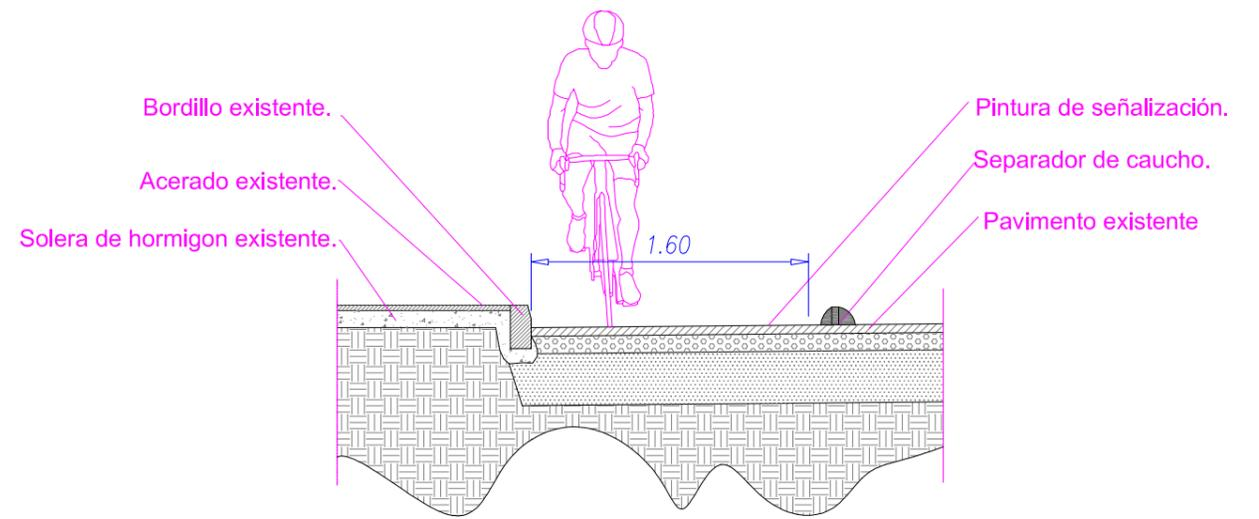
seccion por trasversal de calzada
