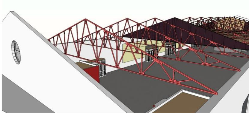
Igualmente, en la zona del escenario existente se llevara a cabo el cerramiento de la cercha de unión entre el exterior e interior de cortinas mediante un panel DM fijado con tornillería anclada a las cerchas para poder adherir una capa de lana de roca de baja densidad y finalmente terminación con tela color negra ignifuga.
